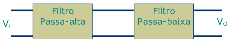
Figura 2.7 – funcionamento filtro PF
