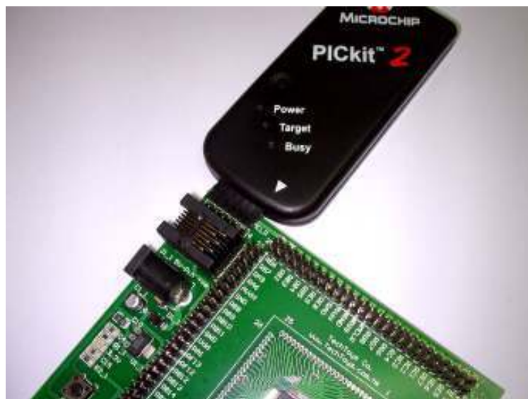
Fig. 4.1 – Figura de gravação do microcontrolador.
