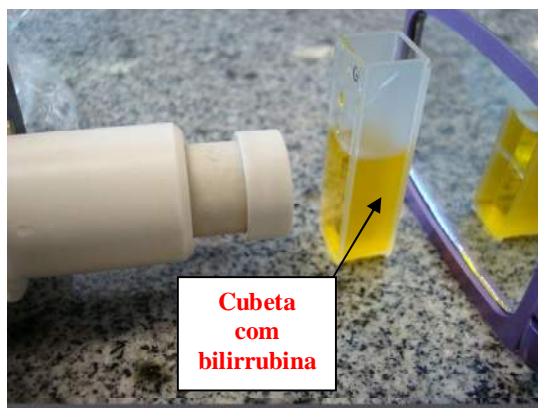
Fig. 6.3 – Cubeta com padrão de bilirrubina sendo lida pelo equipamento
