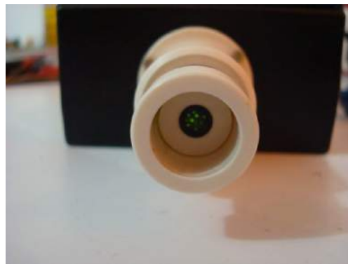
Fig. 5.7 – Condução da luz verde nas fibras ópticas
