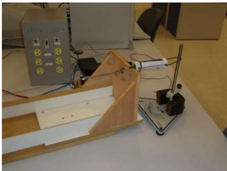
Figura 8 - Aferição utilizando dinamômetro.
